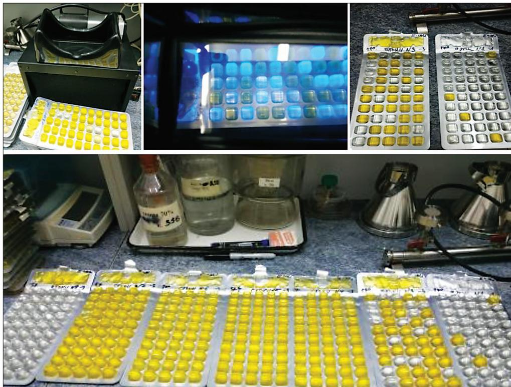
**Рис. 1.** Использование тест-систем фирмы IDEXX для определения бактериального загрязнения.
