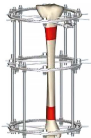
Рис. 2. Схема формирования дистракционного регенерата большеберцовой кости на двух уровнях (билокально) по методу Илизарова.
