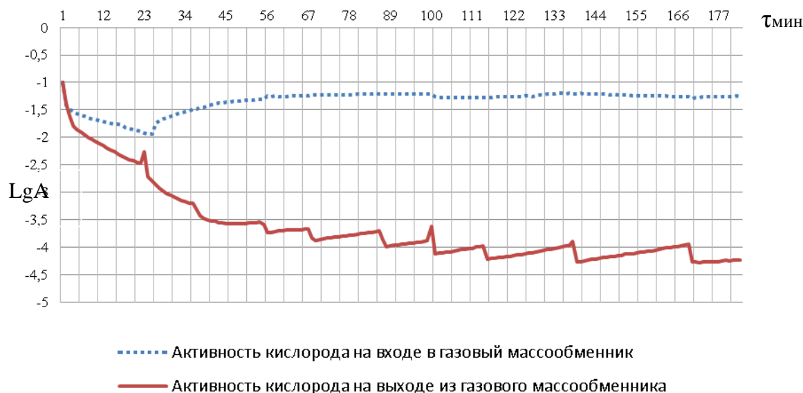
Рис. 3. Изменение окислительного потенциала теплоносителя в процессе эксперимента в серии испытаний на стенде ФТ-3 (температура теплоносителя 450-460°C, расход 0,8 м 3 /ч)
