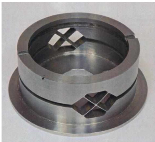
Рис. 5. Макет конструкции корпуса и крестообразных перемычек толщиной 0,065 мм чувствительного упругого элемента гироскопа, выполненные из цельной заготовки (масштаб 5:1)
