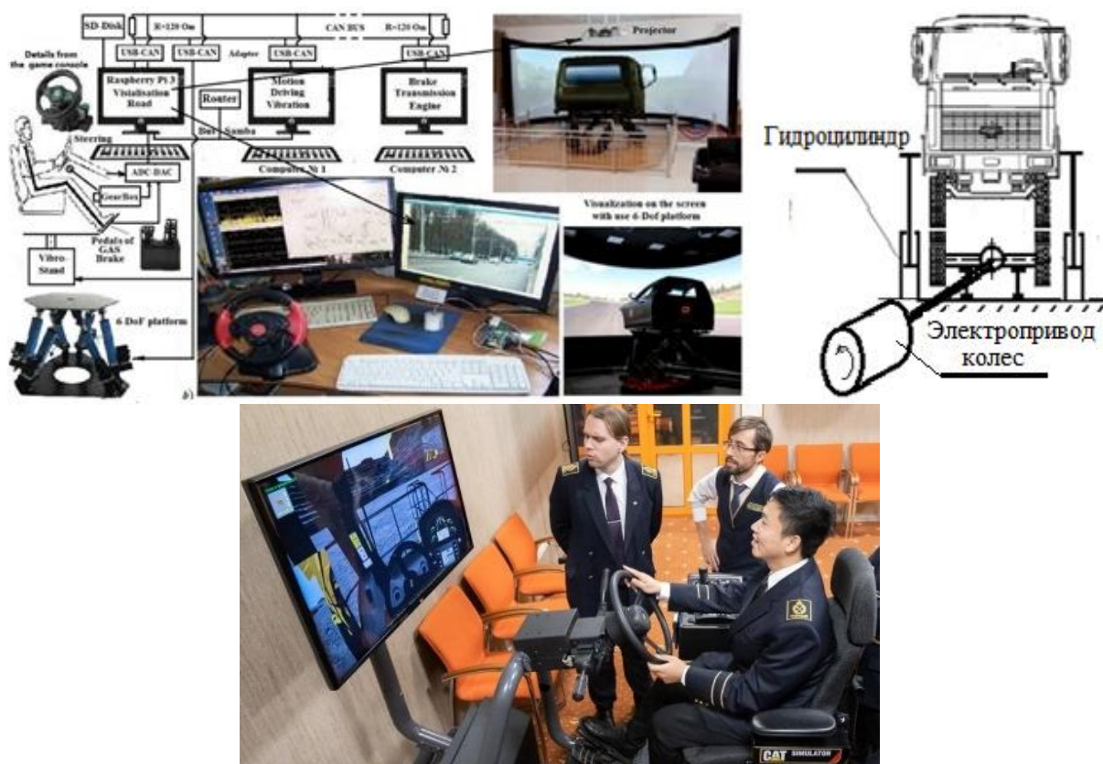
Рис. 2. Схема имитационного моделирования со стендом и макетным настольным образцом, стенд Петербургского горного университета
