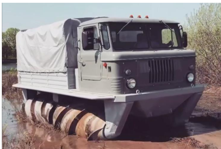
Рис. 1. Внешний вид ТП с РВД ЗВМ-2902
